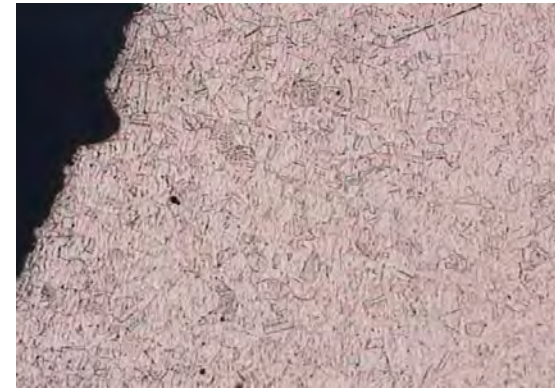
SUS 304 L Failed Area
